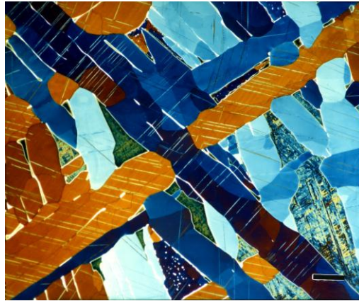
Fig 1b Bristol iron meteorite, Berha Etch, 20x, 500 μm bar (George vander Voort)
