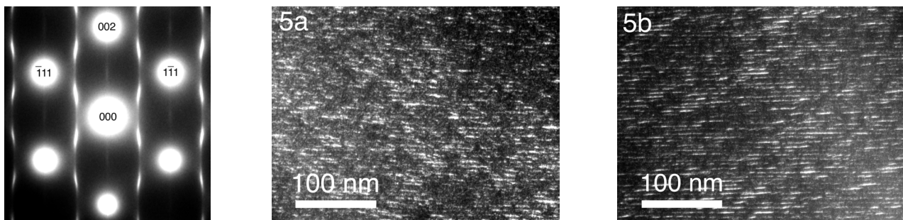
Fig. 5. Domains in [110] XS. a) \frac{1}{2}1\bar{1}1 DF image; b) \frac{1}{2}\bar{1}11 DF image.
